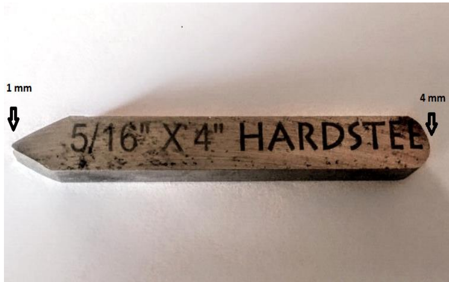
FIGURA 1 – Ferramenta de corte utilizada durante a usinagem dos materiais poliméricos
